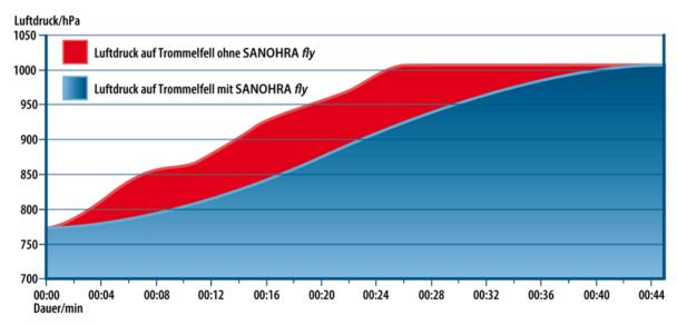
Innerhalb von 25 Minuten wurde der Druck von 773 h/PA auf 1007 h/PA angehoben, dem am Boden herrschenden Luftdruck. Die andere Kurve zeigt den rechnerischen Verlauf des Druckanstiegs am Trommelfell bei der Benutzung von SANOHRA fly.
